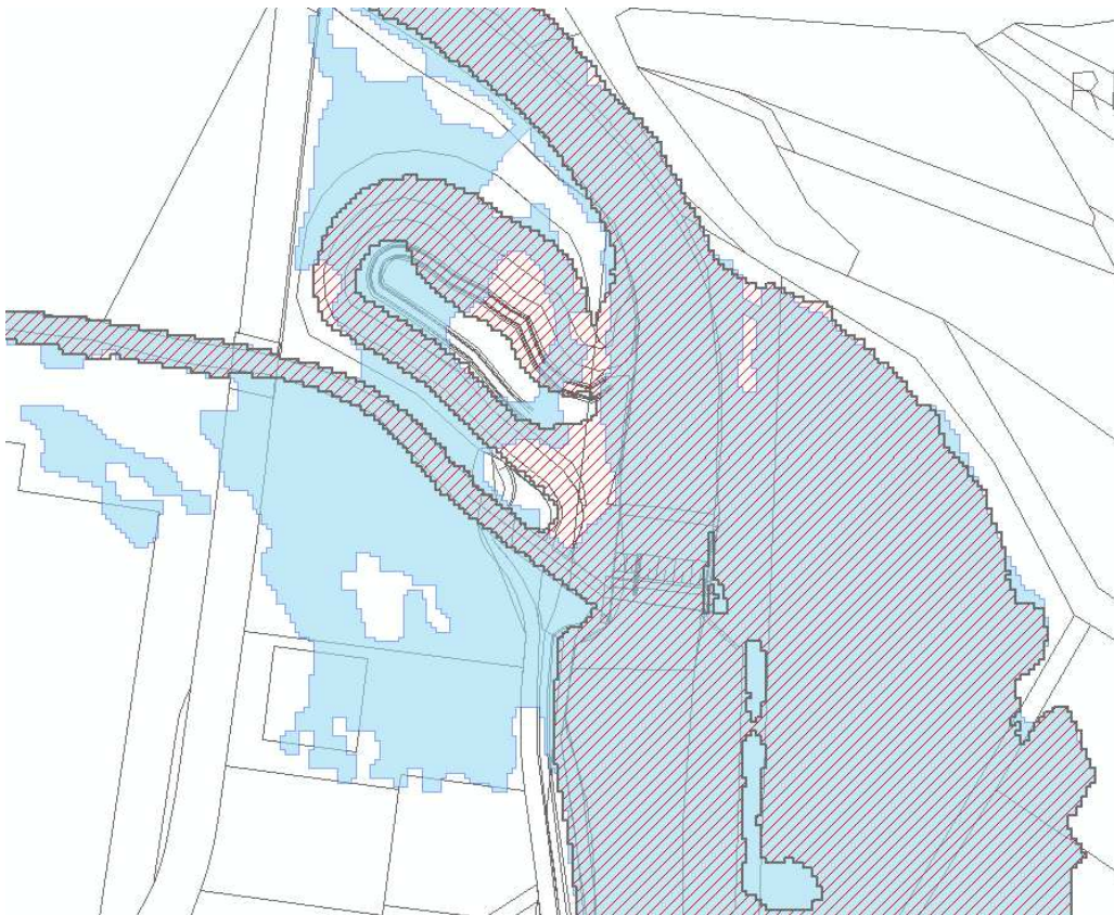
Abbildung 2-5: Vergleich der Überflutungsgebiete im Bereich der Fischaufstiegsanlage für HQ100: Istzustand (blau) und Planzustand (rot-schraffiert)
